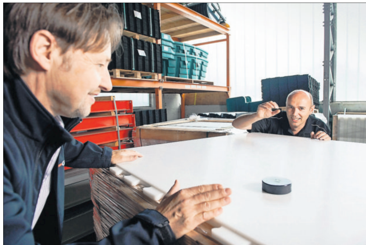
Franz Sigrist (links) und Peter Emmenegger von der Grüter-Handels AG testen die Rutschfläche einer Platte für ein Kunsteisfeld. Bild Roger Gruetter
